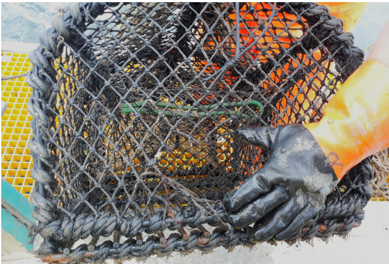
Bilde: Denne teina har hatt råtnetråd sydd inn i nota, som siden har råtnet. Foto: Havforskningsinstituttet/Green-bay AS.
