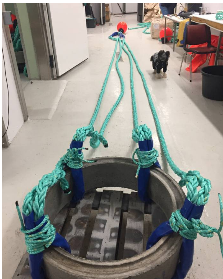
Figur 12. Den funksjonelle enheten i framtidens fjordskog? Blåsa i toppen gir oppdrift, men vil være dykket under overflaten selv ved fjære sjø. De grønne trossene mellom betongring og blåse vil være substrat for tare/skjellvekst.
