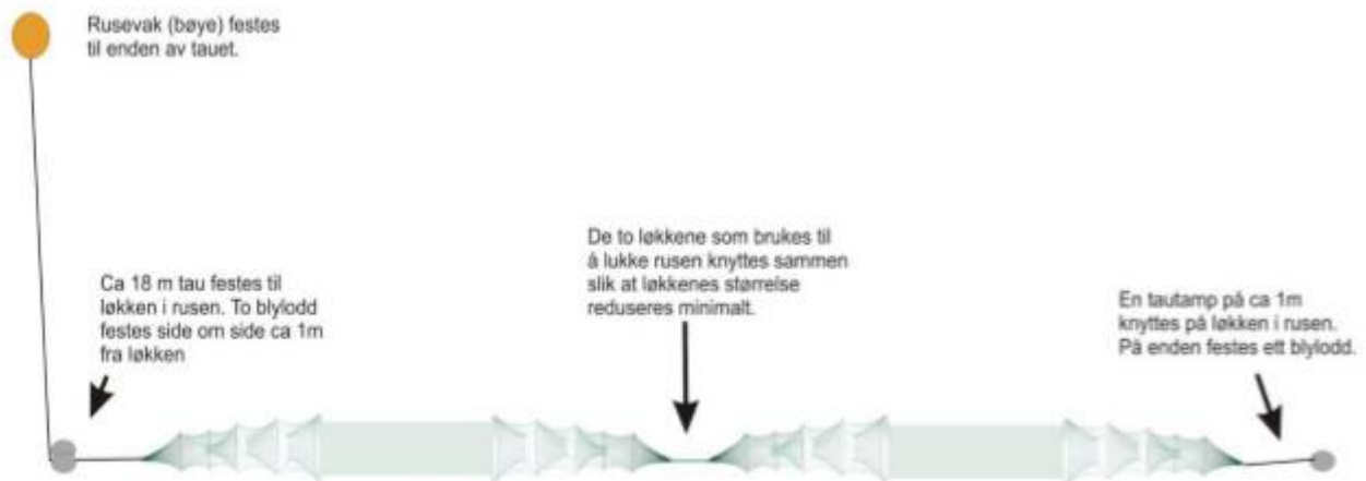
Figur 8. Dobbelt åleruse: Fra venstre; ett rusekammer og 3 kalver, så et ledegarn og 3 kalver og et rusekammer. Andre halvdel er et speilbilde av første (fra van der Meeren, 2018).
