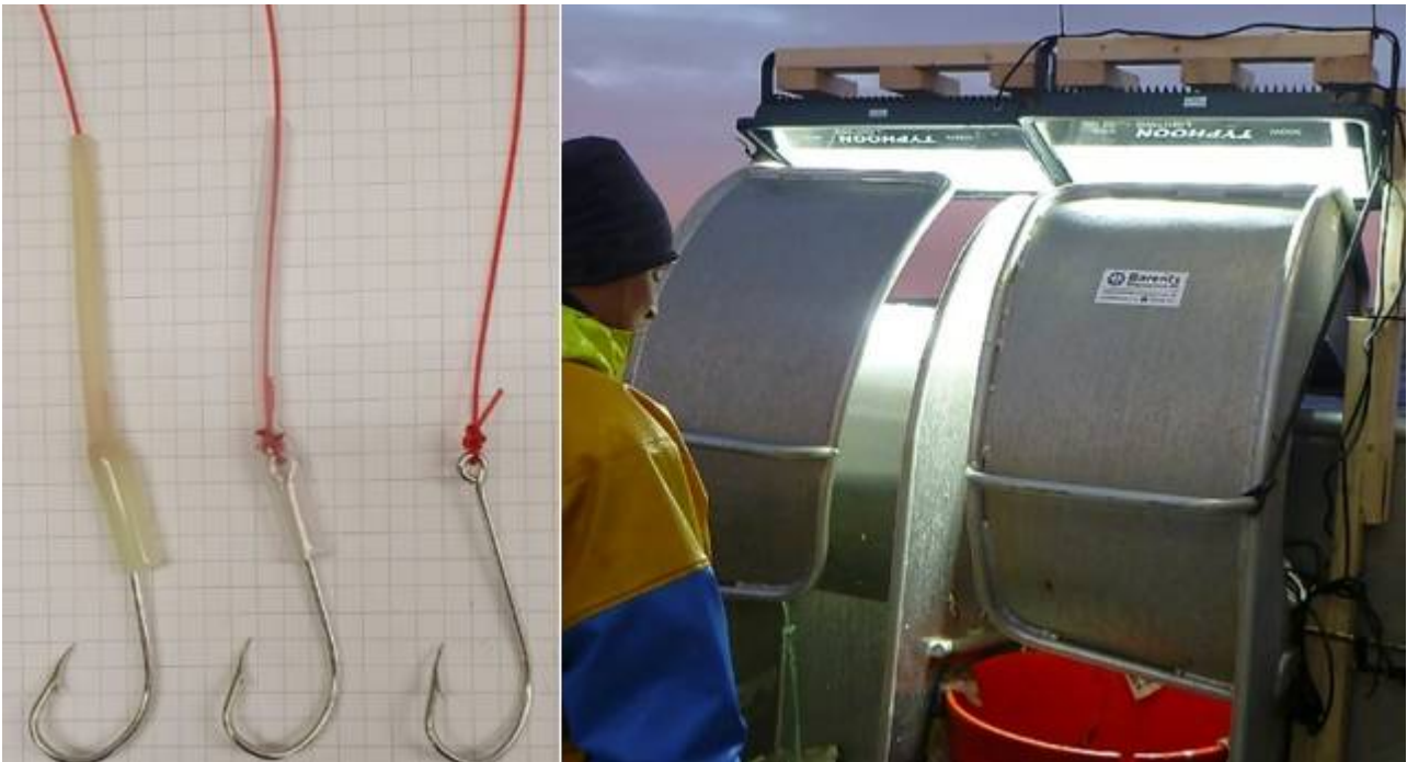
Figur 2 Modifisering av krok og forsyn med selvlysende (venstre) eller gjennomsiktige (midten) hylser og lading under setting med LED lamper.
